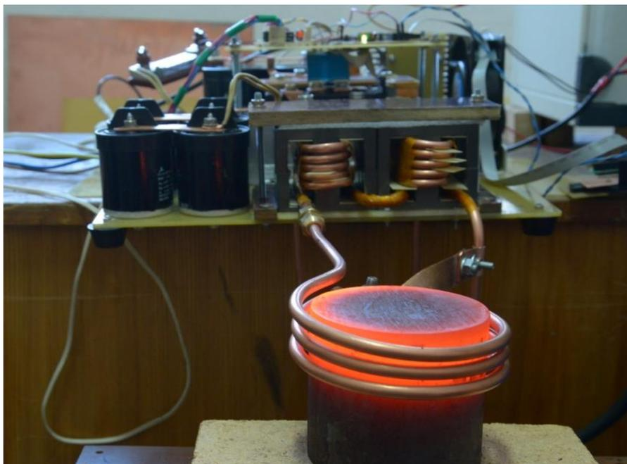
Рис. 2. Процесс индукционного поверхностного нагрева металла диаметром 120 мм при частоте 20 кГц
